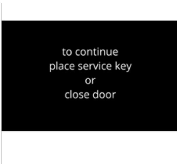
Wenn die Tür geöffnet wird, wird der Sicherheitsschalter aktiviert und eine Meldung angezeigt.
